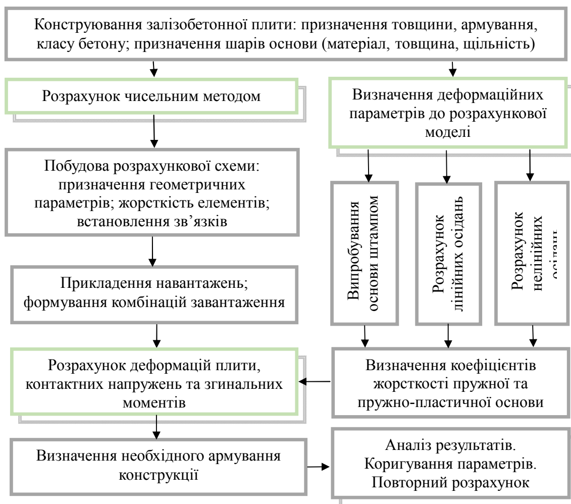
Рис. 2. Алгоритм розрахунку фундаментних плит з урахуванням пружних та пластичних деформацій основи
