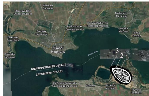
Рис. 3. Ізолінії об'ємної концентрації радіоактивності, t = 190 с: 1 – C = 16 Ки/м 3 ; 2 – C = 38 Ки/м 3 ; 3 – C = 60 Ки/м 3
