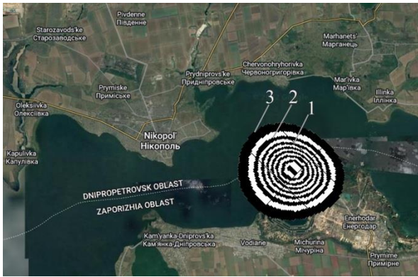
Рис. 5. Ізолінії об'ємної концентрації радіоактивності, t = 1\ 290 с: 1 – C = 8 Ku/m^3 ; 2 – C = 12 Ku/m^3 ; 3 – C = 19 Ku/m^3
