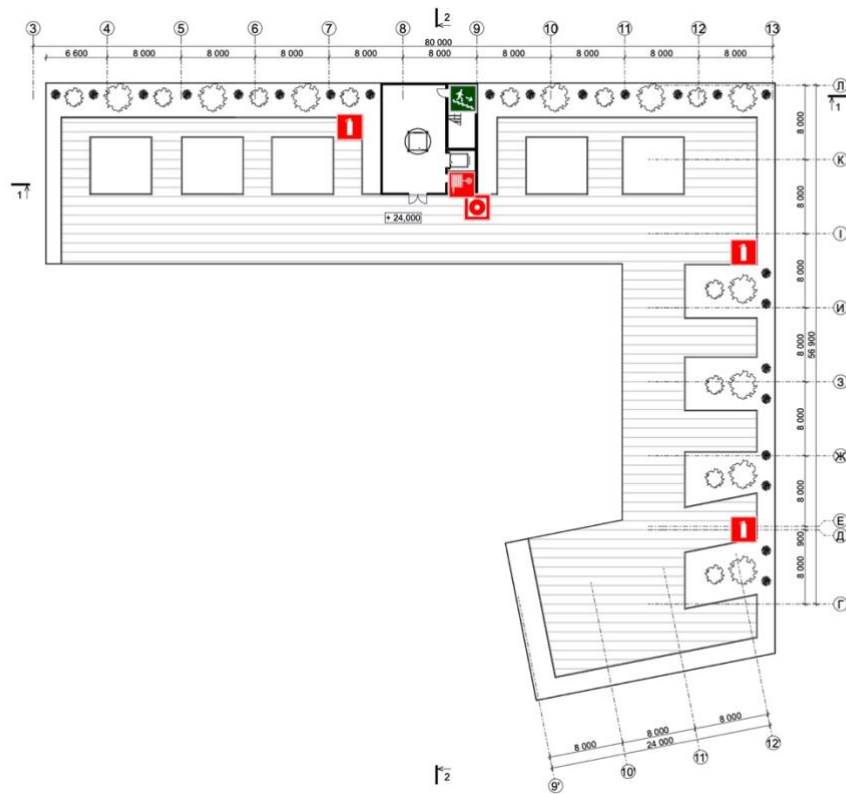
Рис. 3.4. Схема розміщення елементів пожежної безпеки на від. +24.000
