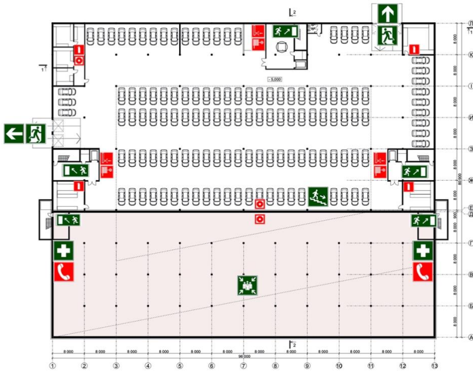
Рис. 3.1. Схема розміщення елементів пожежної безпеки на від. -5.000
