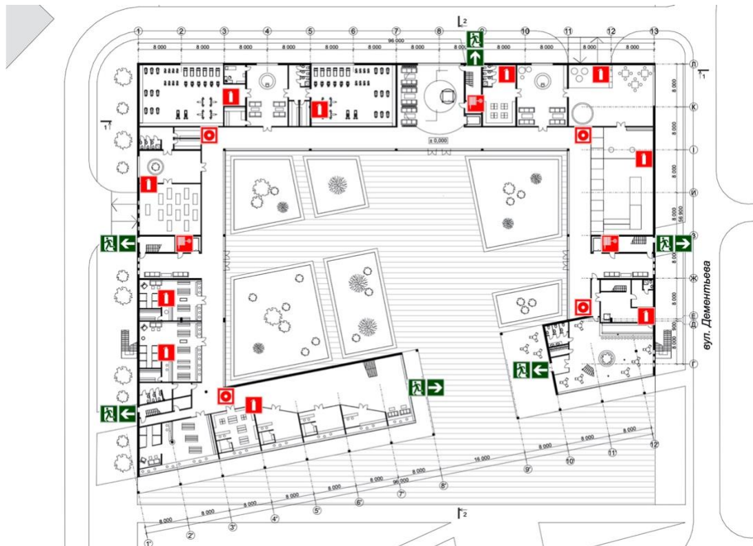
Рис. 3.2. Схема розміщення елементів пожежної безпеки на від. 0.000
