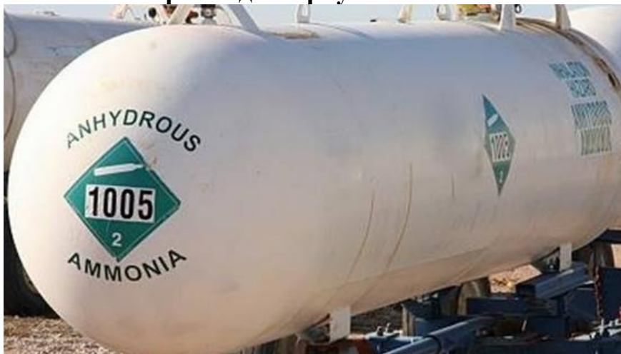
Стационарна ємність з аміаком на промисловому підприємстві
