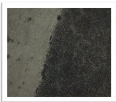
Рис. 6. Мікроструктури композиту із сталі ШХ15Ш в обкладках 40X13 зварювальний шов, ×500
