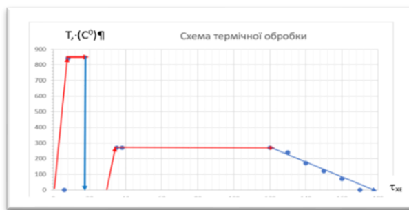
Рис. 2. Схема термічної обробки клинка із композитної сталі ШХ15Ш в обкладках 40X13
