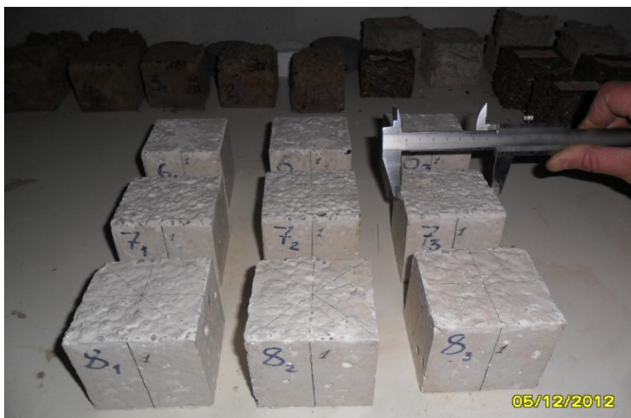
Рис. 2. Измерение размеров образцов для определения усадки и объемного веса бетона
