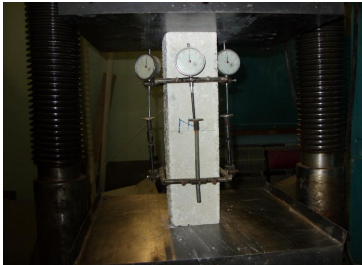
Рис. 3. Испытания призм на прессе
