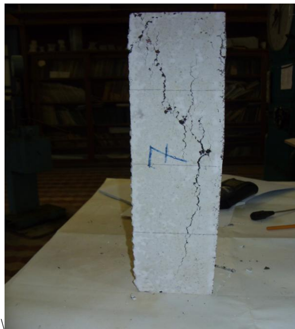
Рис. 4. Характер разрушения призм после испытания на прессе
