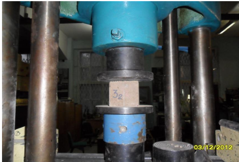
Рис. 1. Определение прочности бетона на сжатие
