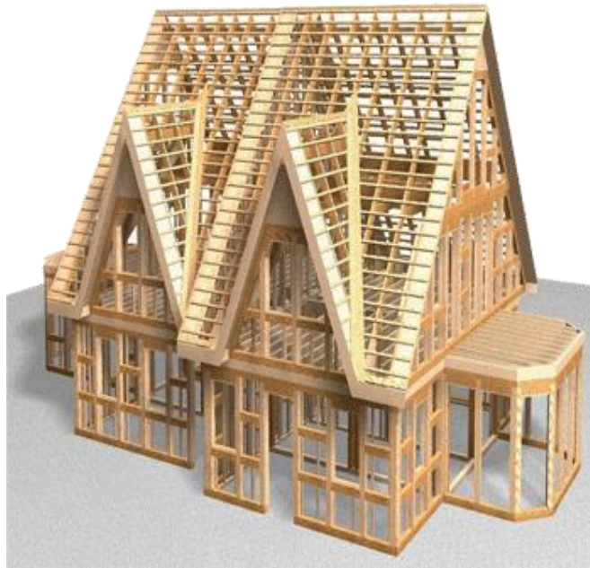
Рис. 2. Дерев'яний каркас швидкозведеного каркасно-панельного будинку
