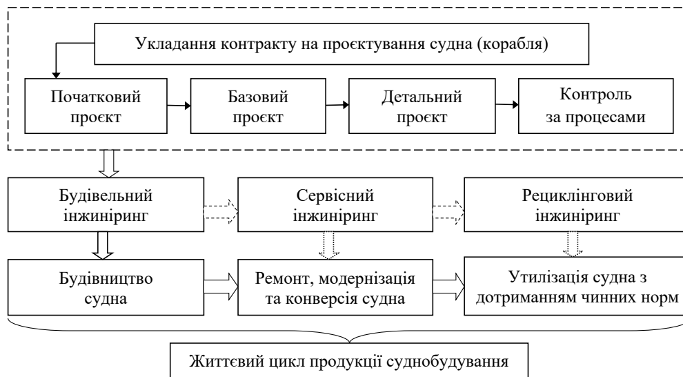
Рис. 2. Місце інжинірингу в життєвому циклі промислових виробів (на прикладі суднобудування)
