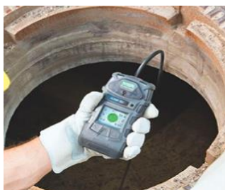
Рис. 2 – Проведення аналізу загазованості в колодязі за допомогою газоаналізатору
