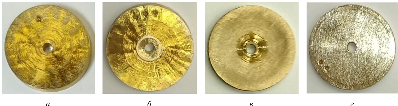
Рис. 1. Вигляд зразків із бронз БрО3А3 (а), БрА5 (б), БрА9ЖЗЛ (в), БрО5Ц5С5 (г) до початку їх випробувань на корозійну стійкість
