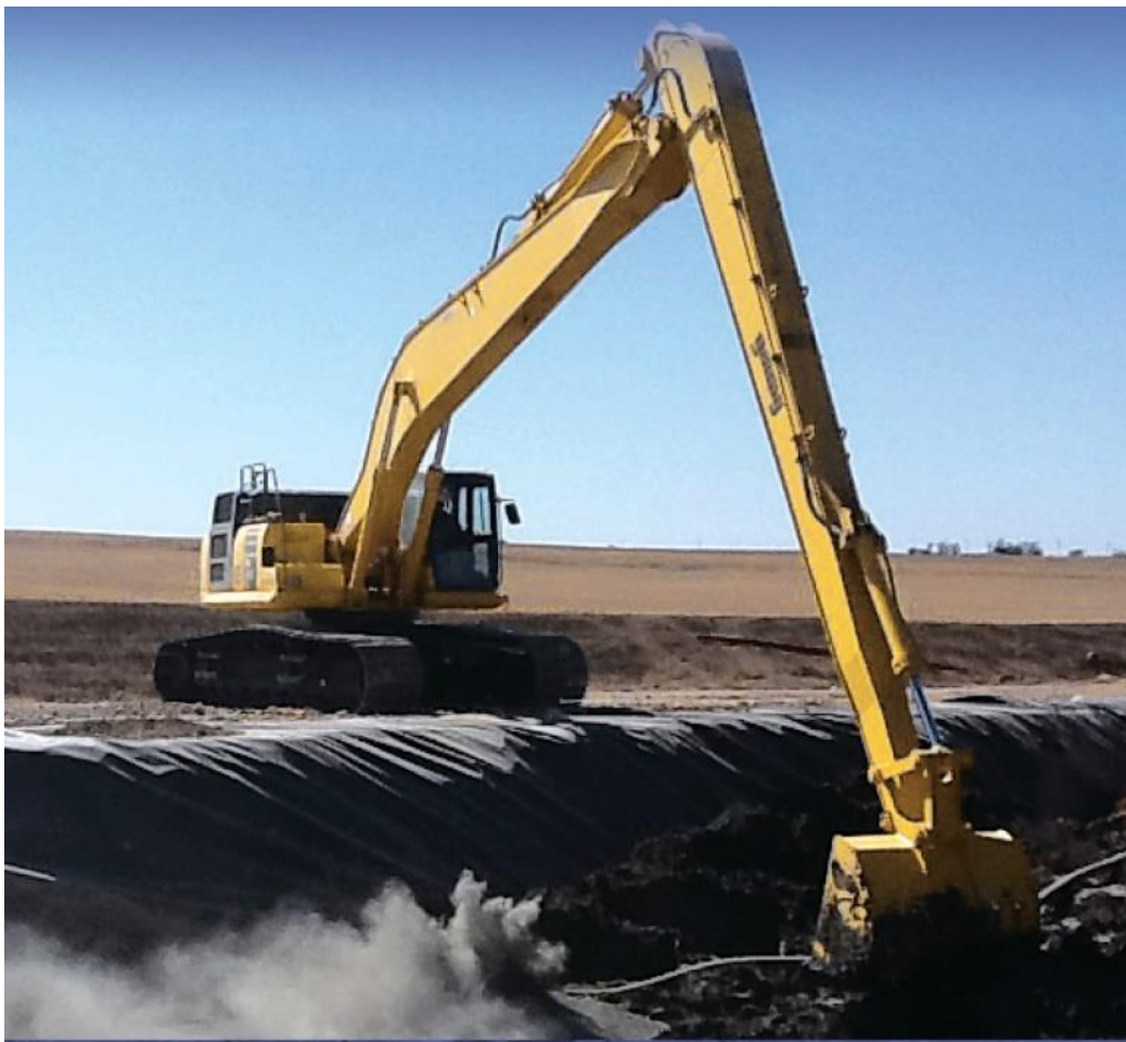
Рис. 1.7. Екскаратори зі збільшеними геометричними параметрами РО при виконанні робіт: а – Hitachi ZX 250LC при роботі на розчистці каналу; б – Komatsu PC 240LC-10 при облаштуванні гідроспоруди
