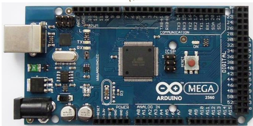
Рис. 3.8. Обладнання для просторового позиціонування елементів ТРО: а – датчик MPU-6050; б – контролер Arduino Mega 2560 Rev3
