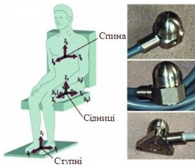
Рис. 4.5. Осі для заміру впливу вібрації на людей, які працюють сидячи (праворуч трьохосьові датчики для вимірювання вібрації – акселерометри)
