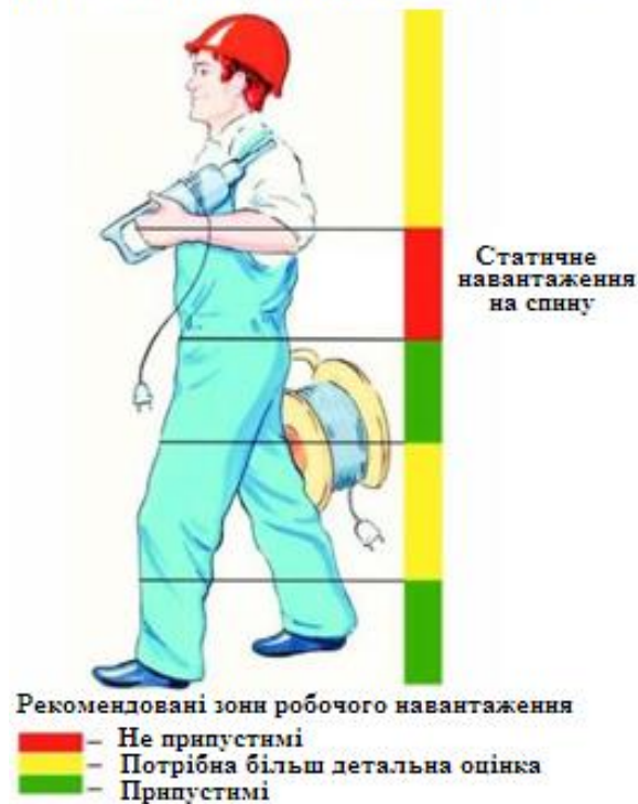
Рис. 1.29. Рекомендовані зони робочих навантажень при перенесенні вантажів
