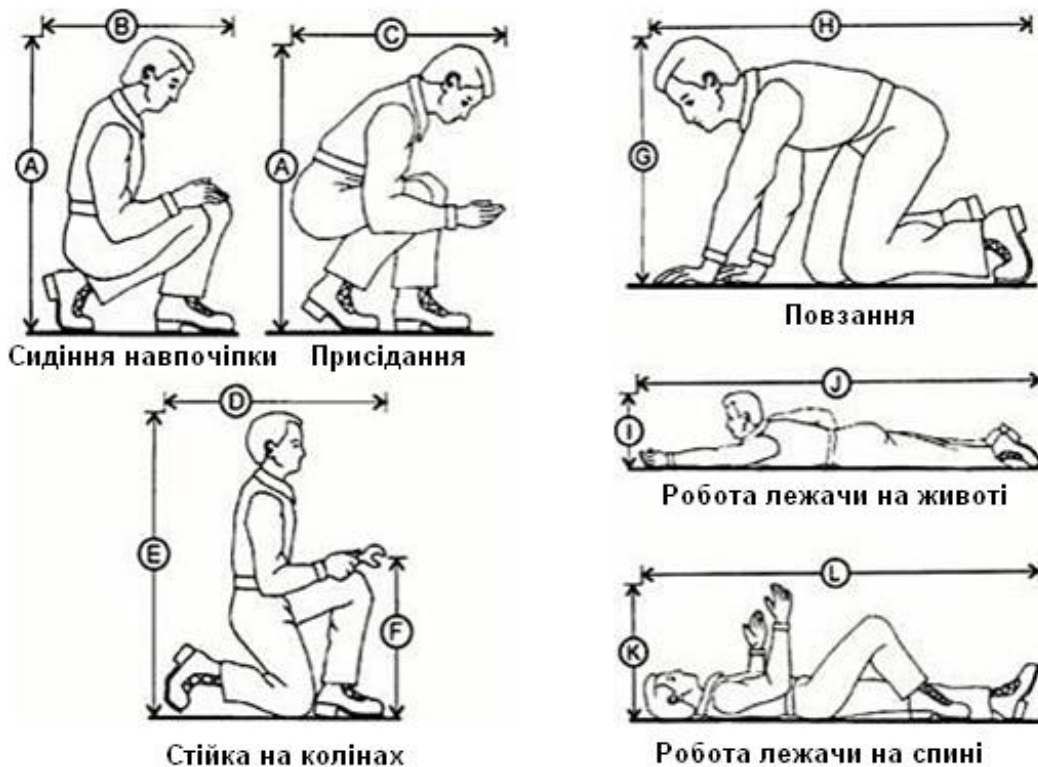
Рис. 1.15. Мінімальні габарити при різних робочих позах
