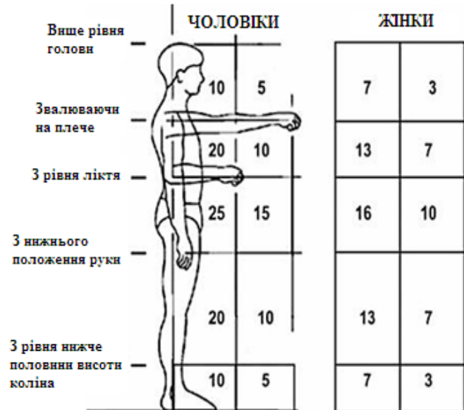
Рис. 7.32. Обмеження маси вантажів, що піднімаються з різних зон захоплення для чоловіків і жінок (кг)
