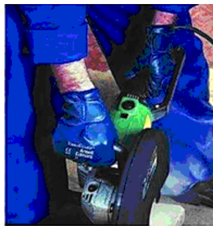
Рис. 7.51. Інструменти зі зменшеною вібрацією
