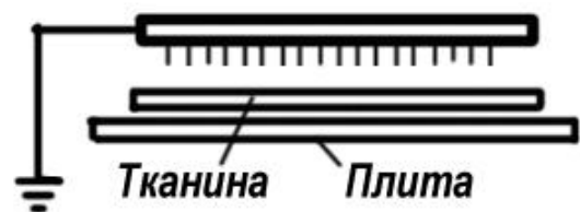
Рис. 1.65. Заземлені металеві щітки
