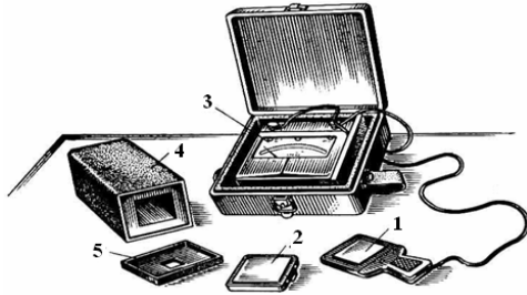
Рис. 2.4.1. Люксметр і насадка до нього для вимірювання яскравості: 1 - фотоелемент; 2 - світлофільтр; 3 - електровимірювальні прилади; 4 - насадка для вимірювання яскравості; 5 - знімна кришка насадки.
