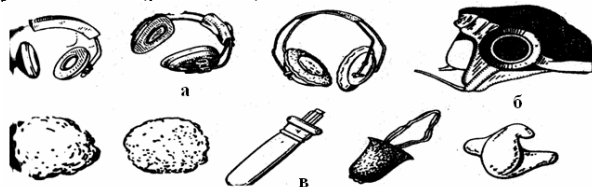
Рис.2.5.7. Засоби індивідуального захисту органів слуху: а - навушники; б - шумозахисний шолом; в - протишумові вкладиші.
