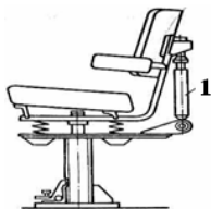
Рис. 2.5.16. Віброізоляція сидіння оператора: 1 - гідроамортизатор
