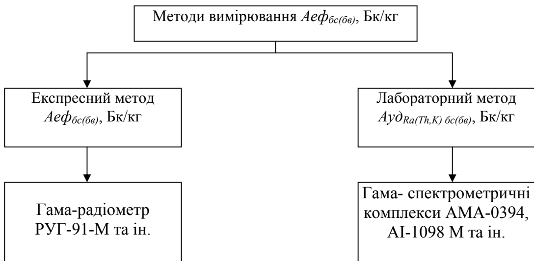
Мал. 6.1. Методи виміру питомої й ефективної питомої активності ПРН у будівельних матеріалах і виробих
