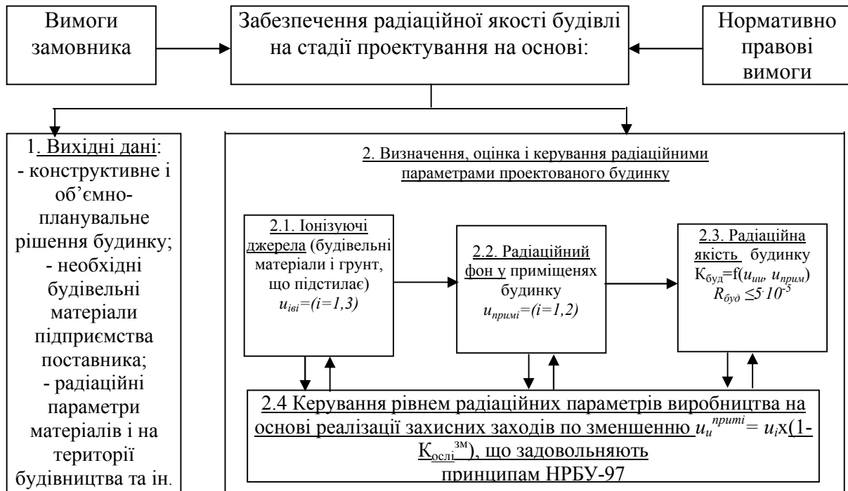
Мал. 9.2. Блок - схема закладки радіаційної якості будинку на стадії проектування
