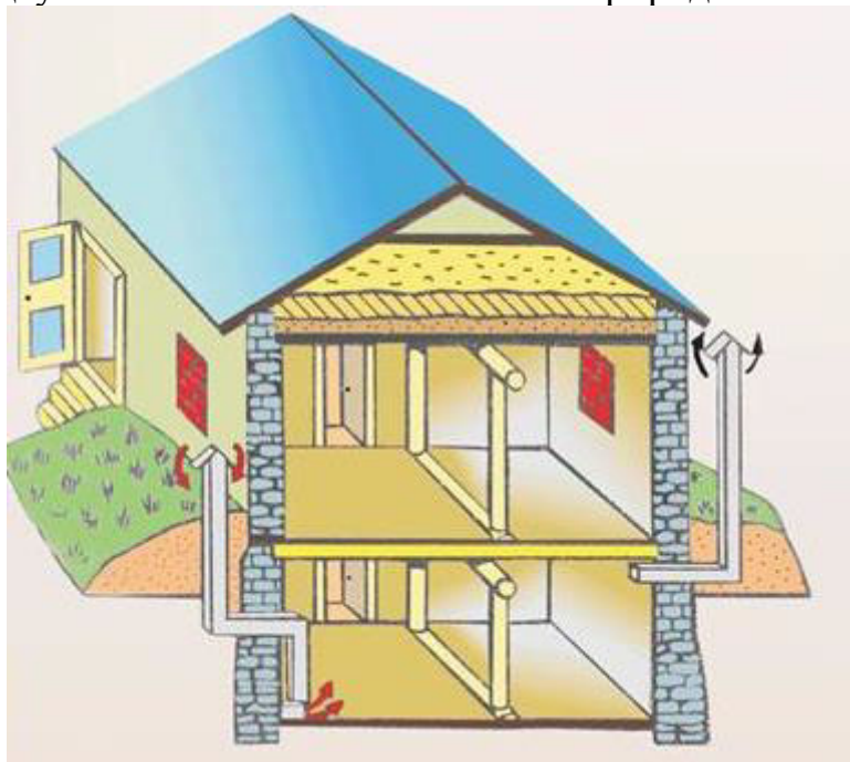
Рис. 9.41. Улаштування системи вентиляції для ПРУ малої місткості
