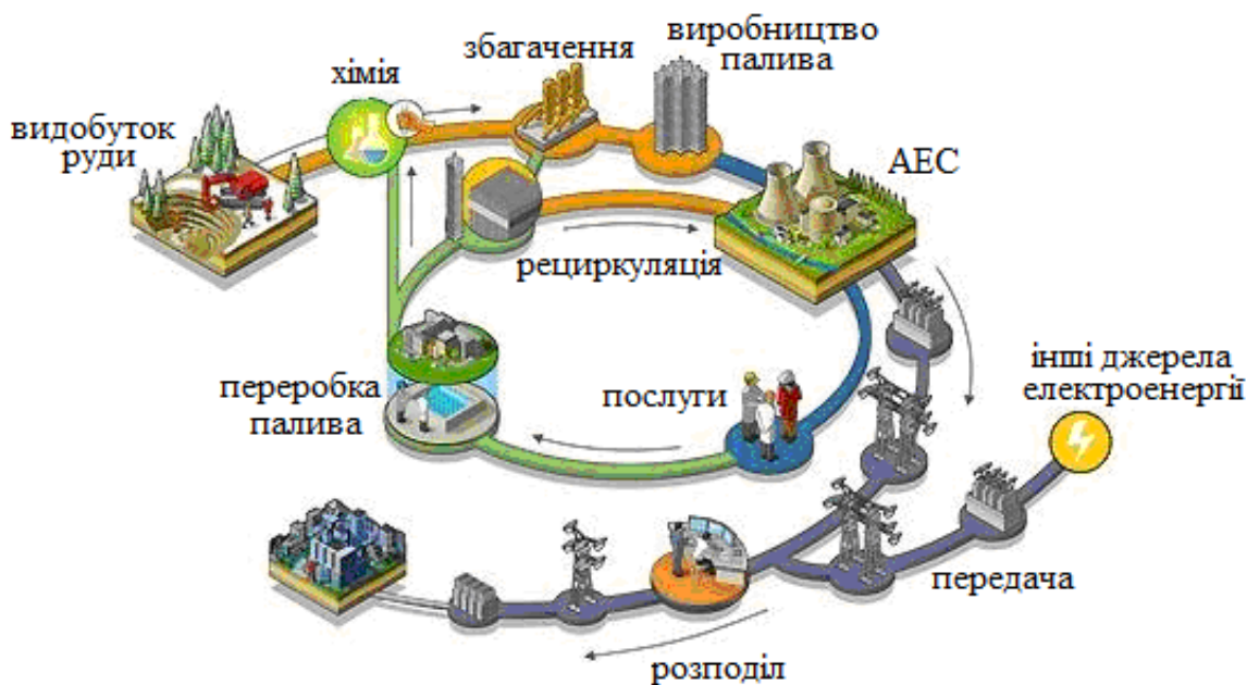
Рис. 6.1. Паливні цикли атомної енергетики
