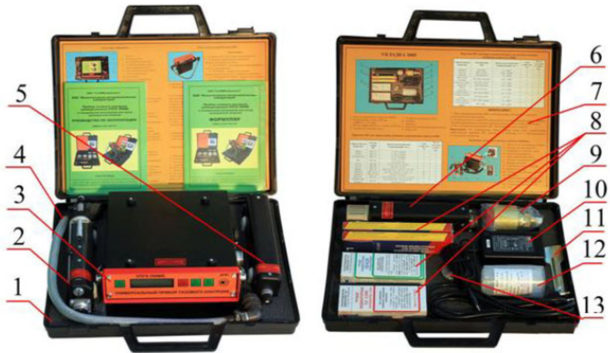
Рис. 10.20. Універсальний прилад газового контролю УПГК-ЛІМБ: 1 – упаковка приладу (кейс); 2 – блок пробовідбору (БПВ); 3 – блок керування (БК); 4 – пневмоелектрокабель; 5 – блок вимірювальний (БВ); 6 – блок отруйних речовин (БОР); 7 – упаковка ЗІП (кейс); 8 – трубки індикаторні (ТІ); 9 – пристрій імітаційний; 10 – пристрій живлення (ПЖ); 11 – лопатка; 12 – комплект імітаційної рецептури КІР-1А; 13 – піддон
