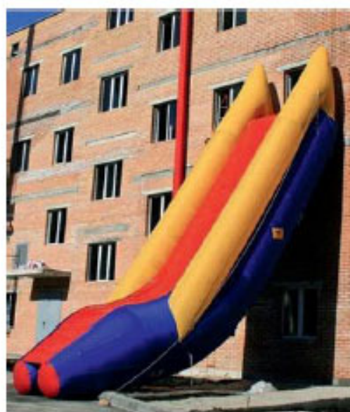
Рис. 10.10. Порятуюнок постраждалих з верхніх поверхів палаючих будівель із застосуванням механічних засобів, пристосувань та пристроїв
