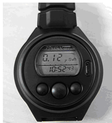
Рис. 10.25. Радіометр наручний «ДКГ-РМ1603А» (індивідуальний)
