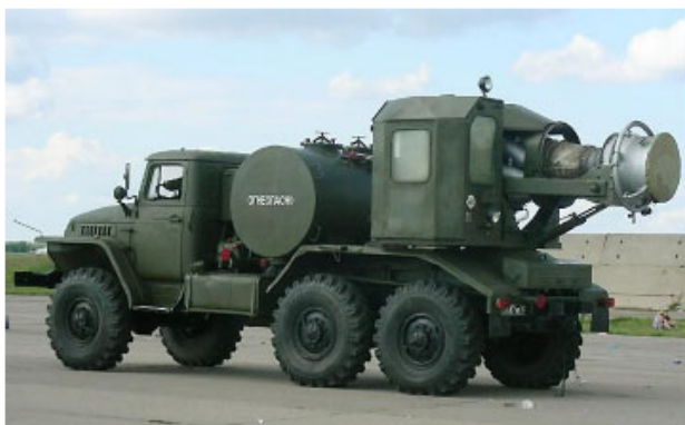
Рис. 10.16. Теплова машина для спеціальної обробки техніки ТМС-65
