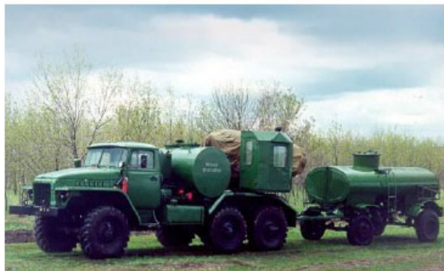
Рис. 10.16. Теплова машина для спеціальної обробки техніки ТМС-65
