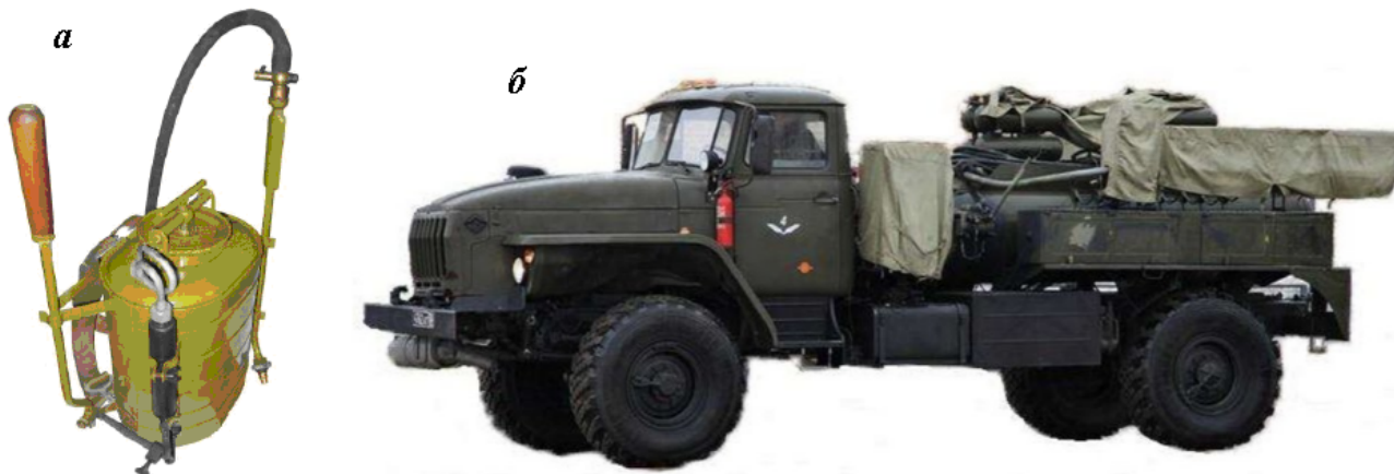
Рис. 10.30. Ранцевий дегазаційний комплект ДК-4 (а); авторозливальна станція АРС (б)
