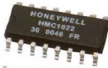
Рисунок 7 - Магніторезистивний датчик НМС 1022 компанії Honeywell
