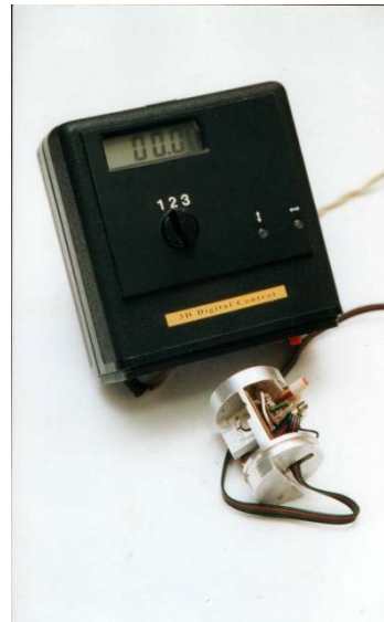
Рисунок 3.4 - Моделі перетворювачів нахилу на основі акселерометрів
