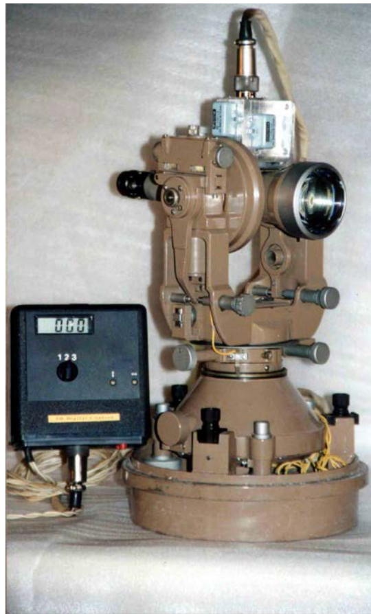
Рисунок 3.11 - Установка для проведення метрологічних випробувань ПН
