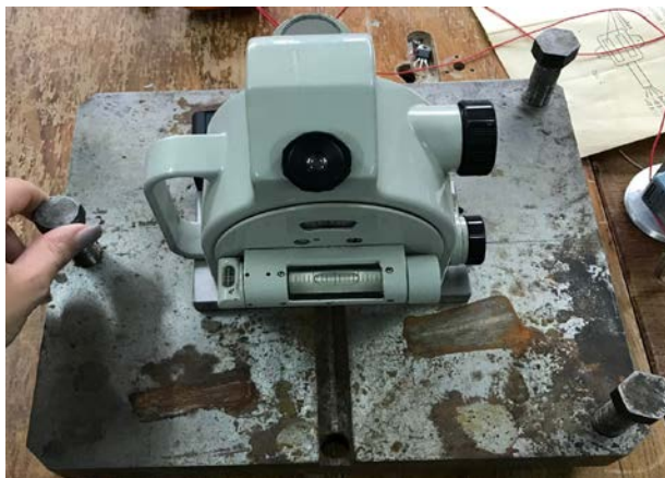
Рисунок 3.23 – Встановлення платформи у горизонталь
