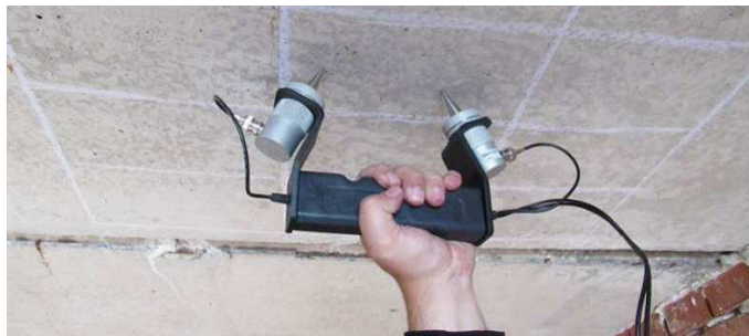
Рис. 1.12.Процес ультразвукового контролю залізобетонної конструкції
