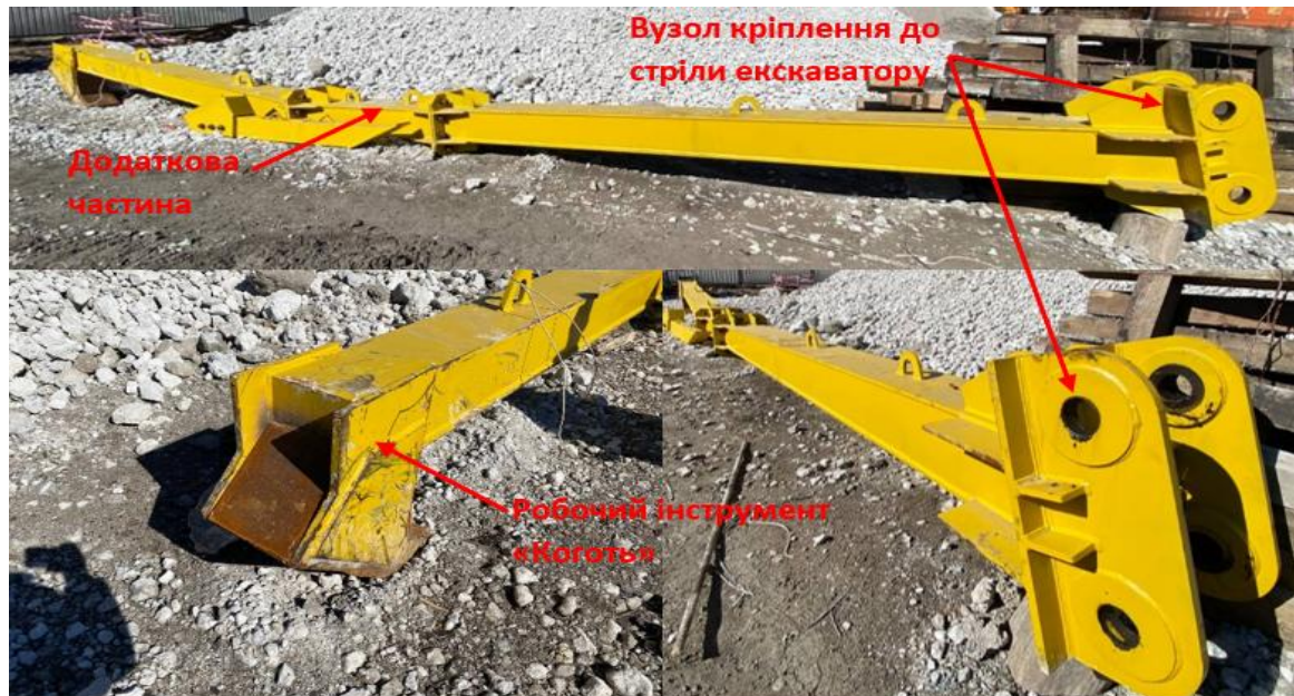
Рис. 9. Фото подовжувача стріли на площадці зберігання
