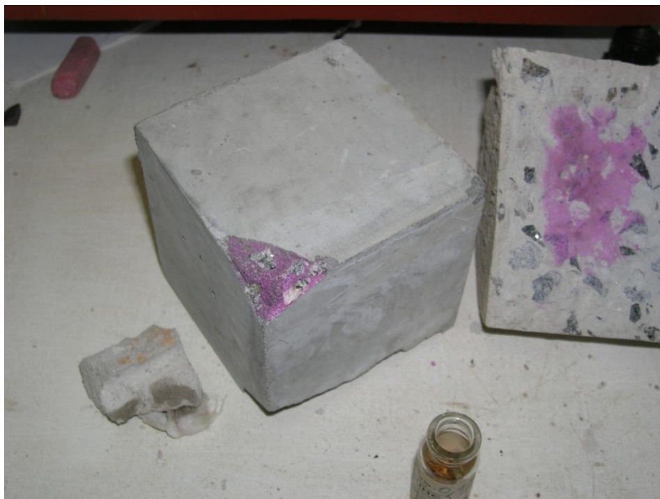
Рис. 3.16. Образцы бетона и раствора с нанесенным индикатором фенолфталеином
