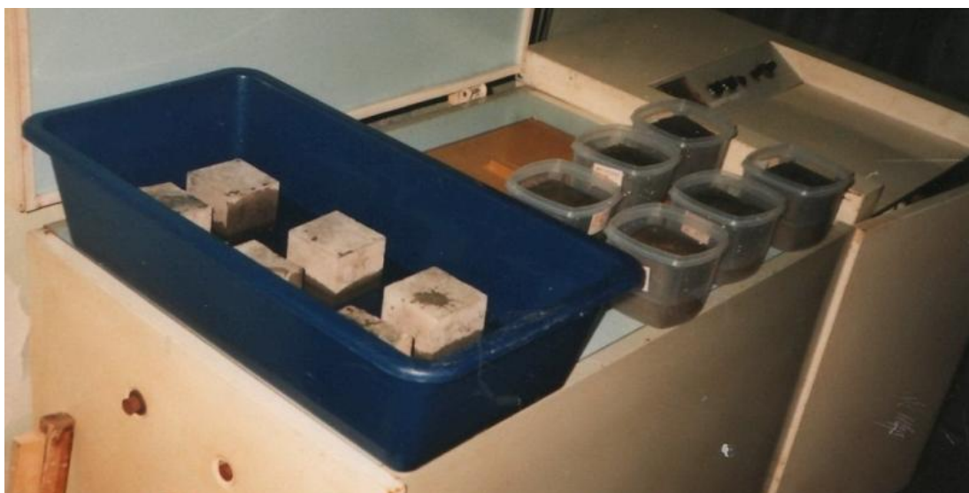
Рис 4.2. Контрольные и основные образцы для испытаний на морозостойкость в процессе водонасыщения
