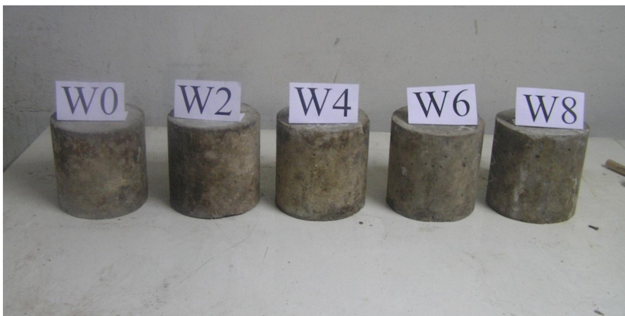
Рис. 3.2. Контрольные образцы бетона в возрасте 23-лет.
