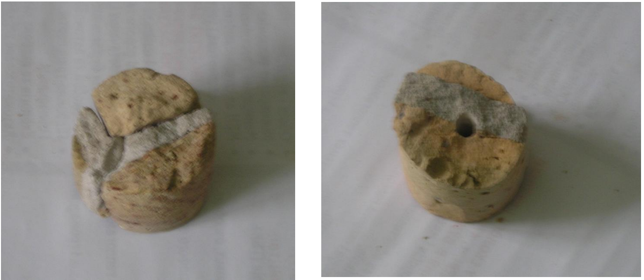
Рис. 3.15. Образцы – керны, выбуренные из стены с кладочным раствором для определения глубины нейтрализации
