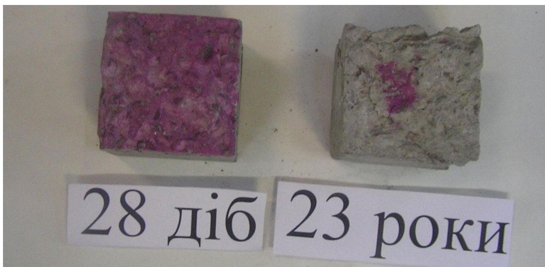
Рис 3.28 Карбонизация бетона образцов разного возраста
