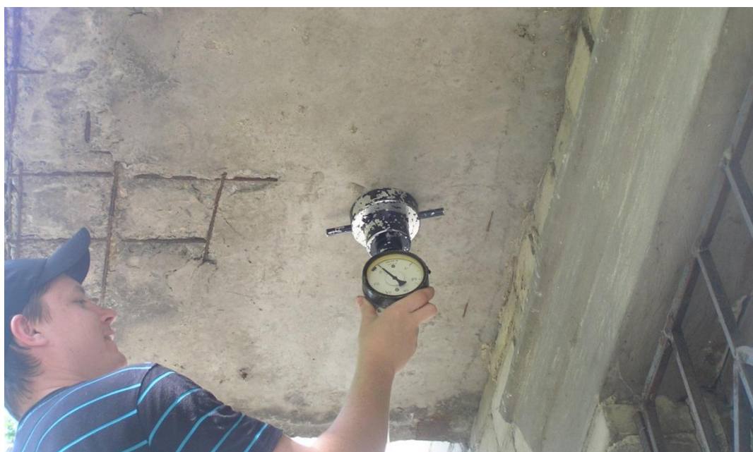
Рис 3.27 Определение водонепроницаемости прибором «Агама»
