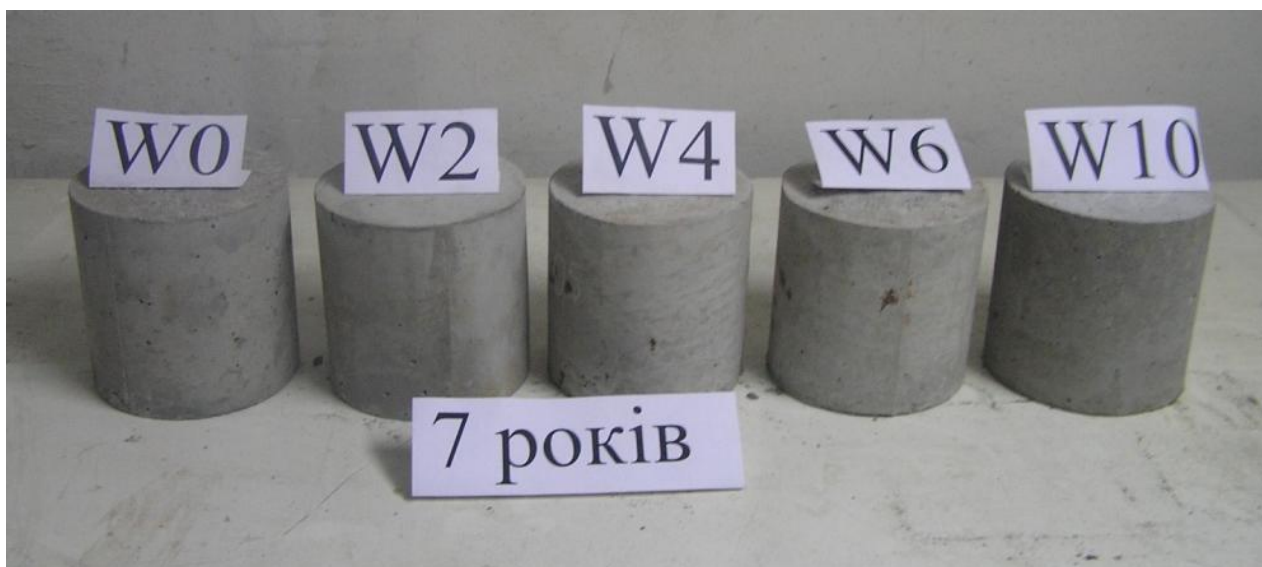
Рис. 3.1 Контрольные образцы бетона в возрасте 7-ми лет
