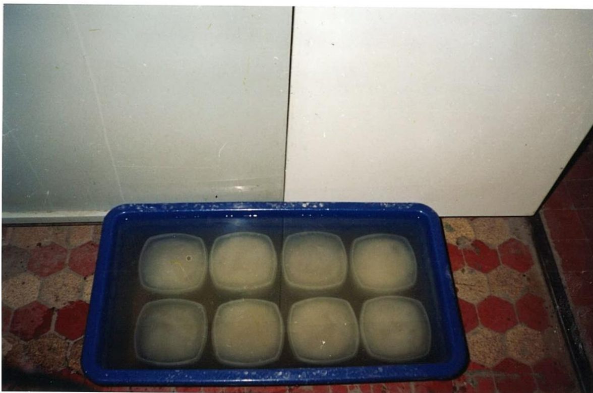
Рис 4.3. Основные образцы в процессе оттаивания в 5-% растворе хлорида натрия
