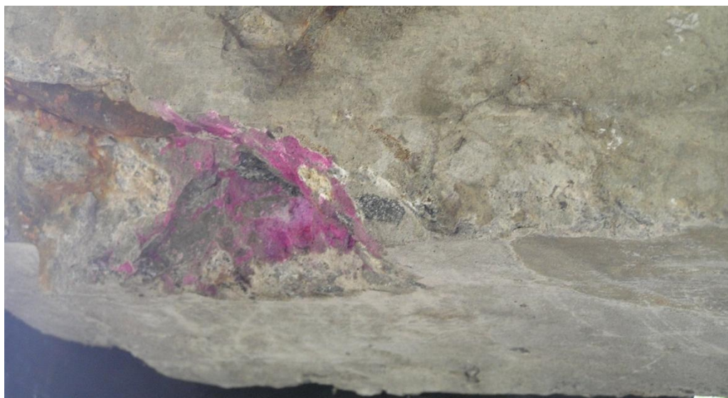
Рис 3.30 Определение глубины карбонизации консольной балки
