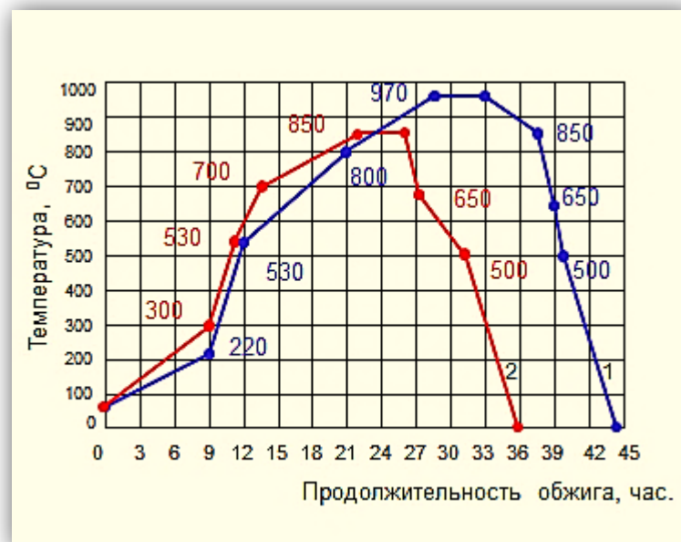
Рис. 5.6. Графики режима обжига стеновых керамических изделий: 1 – на основе керамической массы из природного сырья; 2 – на основе керамической массы из суглинка, ила и Na-Fe-содержащего отхода газоочистки
