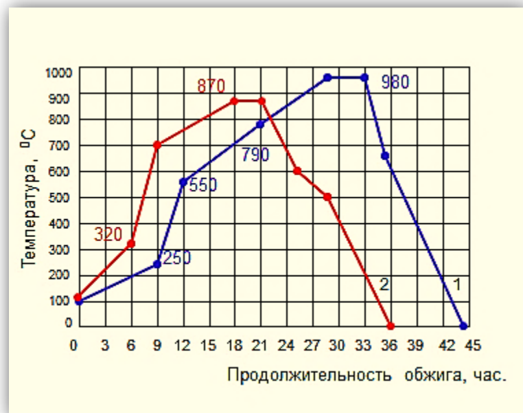
Рис. 5.4. Режим обжига керамического кирпича: 1 – заводского состава; 2 – разработанного состава
