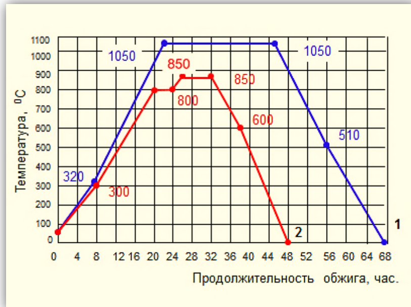
Рис. 5.2. График режима обжига стеновых керамических изделий: 1 – заводской режим обжига изделий следующего сырьевого состава, мас. %: отходы углеобогащения – 50; суглинок – 50; 2 – разработанный режим обжига изделий следующего сырьевого состава, мас. %: отходы углеобогащения – 70; ил – 30
