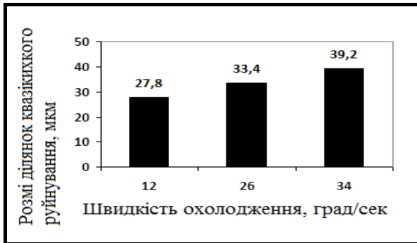
Рис. 4. Кількісний аналіз поверхонь руйнування: а – залежність відсоткового вмісту крихкої складової зламу від швидкості охолодження; б – залежність розмірів ділянок квазікрихкого руйнування від швидкості охолодження
