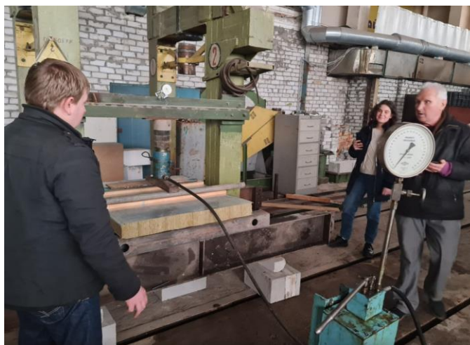
Рис. 2. Випробування на вигин за однопрольотною розрахунковою схемою
