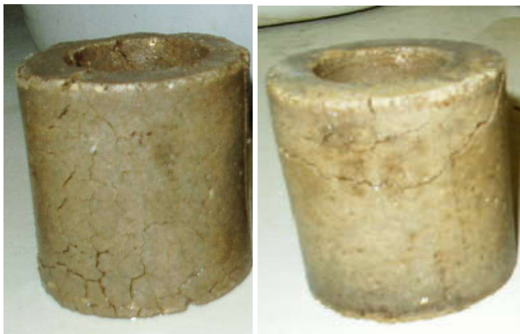
Рисунок 4.5 – Загальний вигляд зразків серії Д-50-КВ-98-ПЧ-02 після 30 років експозиції в 5 % розчині \text{Na}_2\text{SO}_4
