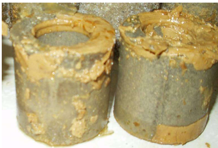
Рисунок 4.7 – Загальний вигляд зразків серії Д-50-КА-93-ПЧ-07 після 30 років експозиції в 5 % розчині \text{Na}_2\text{SO}_4
