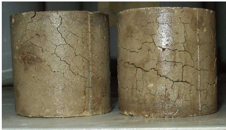
Рисунок 4.3 – Загальний вигляд зразків серії Д-50-КВ-88-ПЧ-12 після 30 років експозиції в 5 % розчині \text{Na}_2\text{SO}_4
