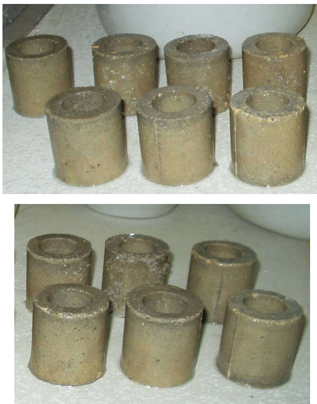
Рисунок 4.1 - Загальний вигляд зразків серії «Д» для експериментальних досліджень корозійної стійкості бетону
