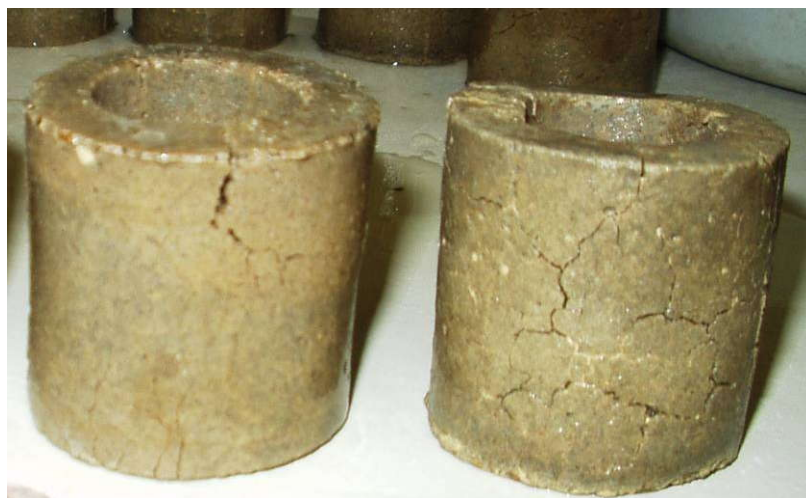
Рисунок 4.4 – Загальний вигляд зразків серії Д-50-КВ-93-ПЧ-07 після 30 років експозиції в 5 % розчині \text{Na}_2\text{SO}_4
