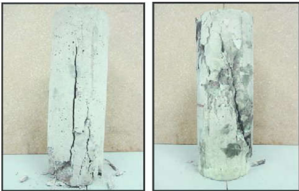
Рисунок 1.2 – Характер тріщиноутворення і руйнування бетону внаслідок сульфатної корозії
