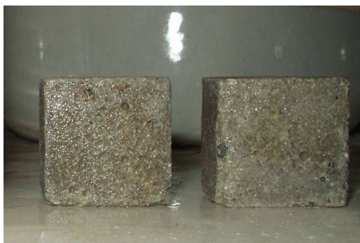
Рисунок 4.10 – Загальний вигляд зразків серії М-50-КА-100-КВ-0 після 30 років експозиції в воді
