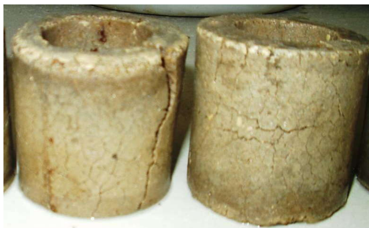
Рисунок 4.6 – Загальний вигляд зразків серії Д-50-КВ-100-ПЧ-0 після 30 років експозиції в 5 % розчині \text{Na}_2\text{SO}_4
