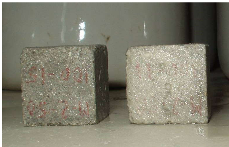
Рисунок 4.9 – Загальний вигляд зразків серії М-50-КА-100-КВ-0 після 30 років експозиції в воді
