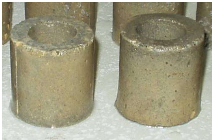
Рисунок 4.8 – Загальний вигляд зразків серії Д-50-КА-88-ПЧ-12 після 30 років експозиції в 5 % розчині \text{Na}_2\text{SO}_4
