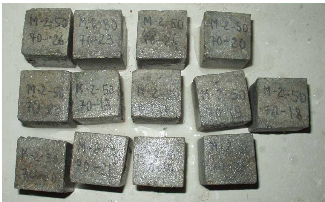
Рисунок 4.2 - Загальний вигляд зразків серії «М» для експериментальних досліджень корозійної стійкості бетону
