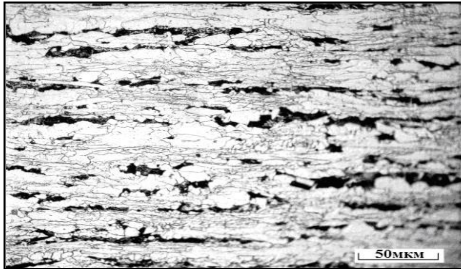
Рисунок 5.8 – Контрольована прокатка: a – загальна технологічна схема; б – мікроструктура прокату (сталь 10Г2ФБ)
