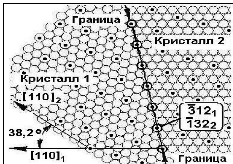
Рисунок 1.13 – Розташування атомів в кубічній решітці при повороті на 36,86^\circ навколо вісі [100] з формуванням решітки співпадаючих вузлів \Sigma = 5 (а); границя проходить по площині (311)_1 \parallel (1\bar{1}3)_2 з високою щільністю співпадаючих вузлів; графічне зображення РСВ (б) (згідно роботи [87])
