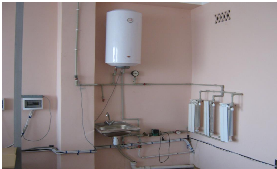
Рис. 2 Экспериментальная установка системы контроля и подачи тепловой энергии.
