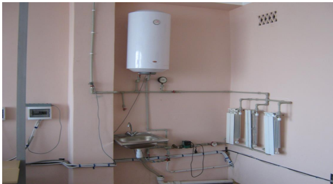
Рис. 5.11 Экспериментальная установка системы контроля и подачи тепловой энергии.
