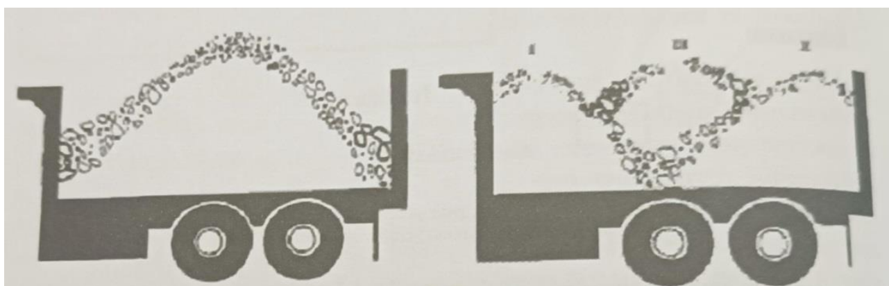
Рис. 3. Неправильна (зліва) та правильна (справа) схеми завантаження автосамоскидів асфальтобетонною сумішею
