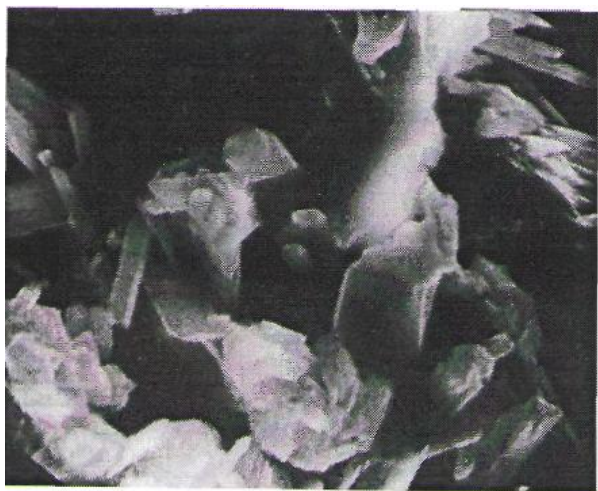
Рис. 3. Электронная микрофотография поверхности скола гипсового образца ( \times 3\ 500 )
