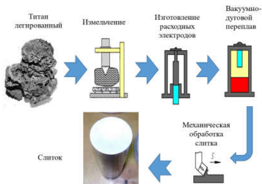
Рис. 2 – Технологическая схема получения титановых сплавов [9] / Technological scheme for the production of titanium alloys [9]
