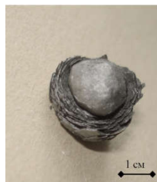
Рис. 4 – Вид заготовки титанового сплава после гидрирования / Type of billet of titanium alloy after hydrogenation
