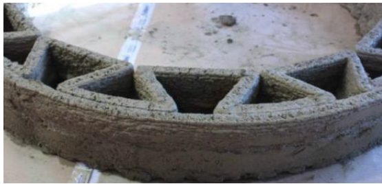
Рис. 5. Строительные конструкции армированные: а – фиброволокном; б – перегородками /
