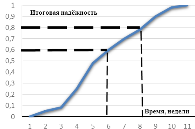
Рис. 3. Итоговая функция времени окончания работ / The final function of the work completion time
