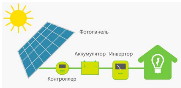
Рис. 2. Схема автономной солнечной электростанции/ The scheme of an autonomous solar power station
