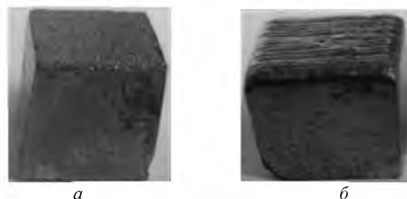
Рисунок 2 — Внешний вид образцов до (а) и после (б) моделирования процесса 3-D печати / Appearance of the samples before (a) and after (b) the modeling of 3-D printing process
