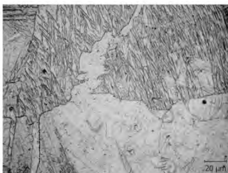
Рис. 1. Микроструктура заготовок из титана, легированного кислородом, после ИПД при 550 °С / Microstructure of oxygen alloyed titanium blanks after SPD at 550 °С
