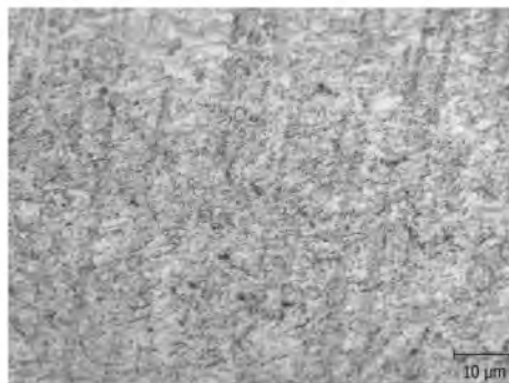
Рис. 2 Микроструктура заготовок из титана, легированного кислородом, после ИПД при 350 °С / Microstructure of oxygen alloyed titanium blanks after SPD at 350 °С
