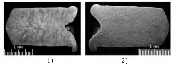
Рис. 1. Влияние модифицирования порошком TiAl на макроструктуру алюминиевой отливки:
