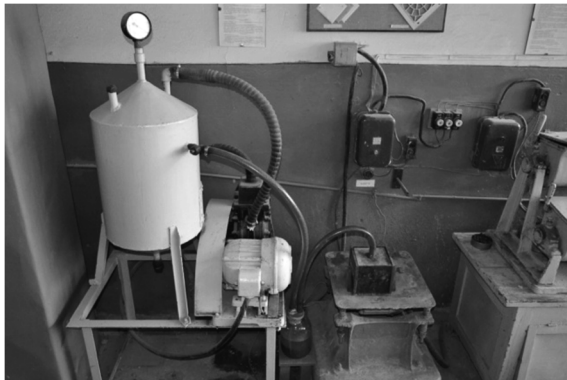
Рис. 1. Общий вид вакуумустановки при формировании экспериментальных образцов/ General view of the vacuum machine when molding experimental samples
