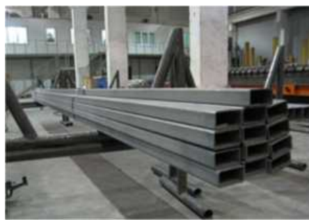
Рис. 5. Внешний вид диффузионно оцинкованных труб прямоугольного и круглого сечения для строительных конструкций / Appearance of diffusion zinc-coated rectangular and round tubes
