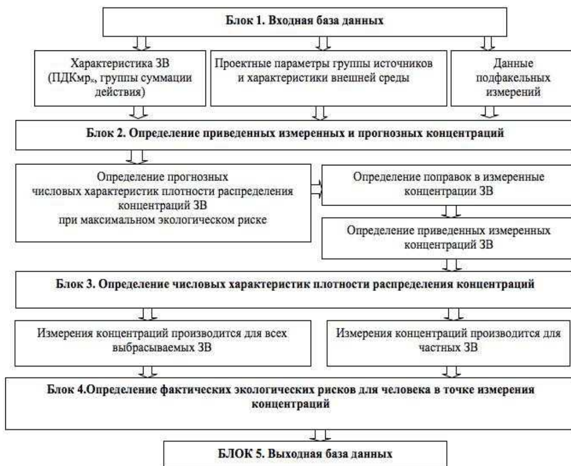
Рис. 1. Структурная блок-схема модели для группы точечных источников выбросов Structural block diagram of a model for a group of point sources
