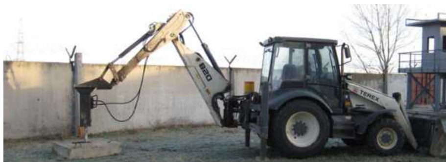
Рис. 4. Имитация сейсмического воздействия / Fig. 4. Imitation of the seismic action
