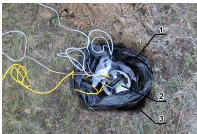
Рис. 3. Обустройство временного пункта сейсмологических наблюдений (сейсмометр GURALP CMG-40TD) / Fig. 3. Construction of a temporary seismological observation points (seismometer GURALP CMG-40TD)
