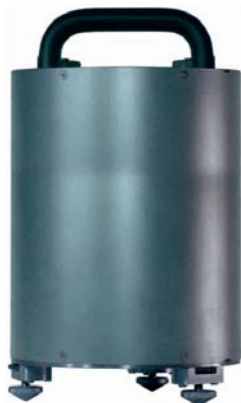
Рис. 2. Сейсмометр GURALP CMG-40TD / Fig. 2. Seismometer GURALP CMG-40TD
