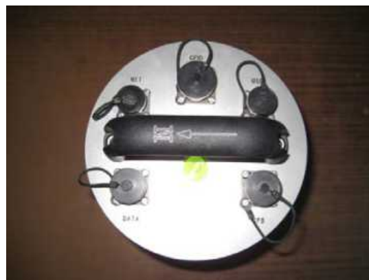
Рис. 2. Сейсмометр GURALP CMG-40TD / Fig. 2. Seismometer GURALP CMG-40TD
