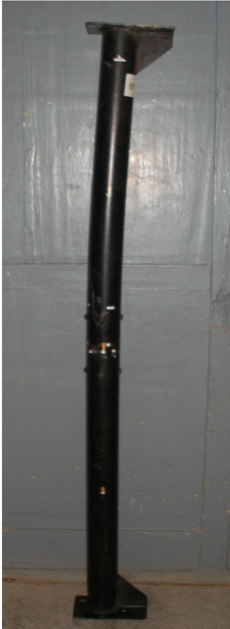
Рис. 4. Характер руйнування трубобетонного зразка / Fracture pattern
