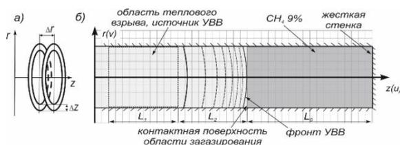
Рис. 1. Общая структура расчётной сетки: а) в объёмном представлении, в цилиндрической системе координат; б) в плоском представлении / The general structure of the computational grid
