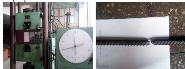
Рис.6. Випробування арматури на розрив Gap testing of armature
