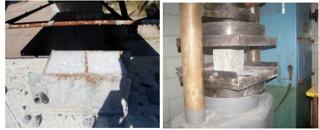
Рис.5. Дослідні бетонні зразки-куби та їх випробування
