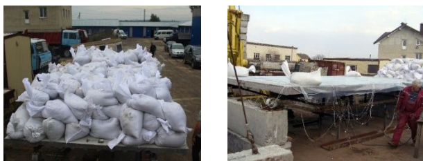
Рис. 12. Навантаження дослідних зразків
