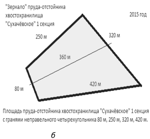
Рис. 5. а – проектная расчетная конфигурация «зеркала» пруда-отстойника хвостохранилища «Сухачёвское» 1 секция; б – фактическая расчетная конфигурация «зеркала» пруда-отстойника хвостохранилища «Сухачёвское» 1 секция
