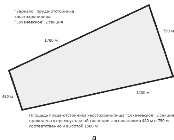
Рис. 6. а – проектная расчетная конфигурация «зеркала» пруда-отстойника хвостохранилища «Сухачёвское» 2 секция; б – фактическая расчетная конфигурация «зеркала» пруда-отстойника хвостохранилища «Сухачёвское» 2 секция
