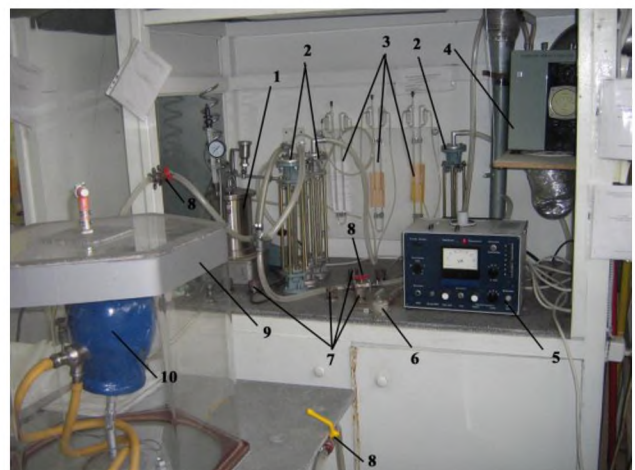
Рис. 5. Загальний вигляд стенду: 1 – генератор аерозолу; 2 – ротаметри; 3 – мікроманометри рідинні; 4 – аспіратор; 5 – інтегральний фотометр; 6 – трьохходовий вентиль; 7, 8 – регульовані вентилі; 9 – випробувальна камера; 10 – спеціальна насадка для закріплення півмаски або муляж голови (для фільтрів тільки насадка) / Overall
