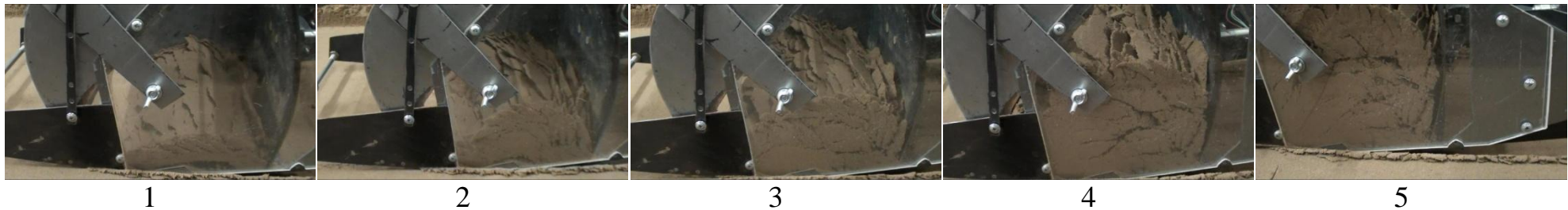
Рис.1.3. Фотограми процесу копання КС з НПД при h_{\text{коп}} = 18 мм: 1-5 - фотограми набору ґрунту у КС з НПД
