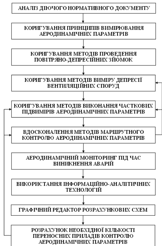
Рис. 3. Методика проведення повітряно-депресійних зйомок / Method of conducting of the air-depressed surveys
