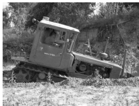
Рис 1. Экспериментальные исследования бульдозера с гидроаккумулирующей системой
