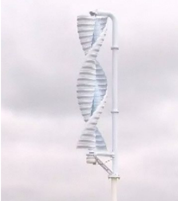
Рис. 6. Вертикальная ветровая турбина для городской местности, не создающая шума и вибраций
