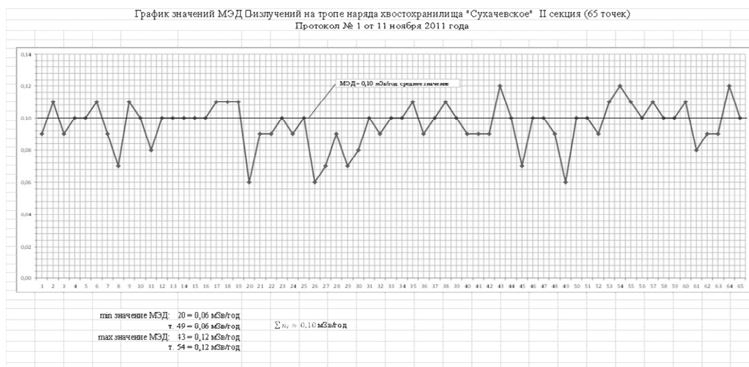
Рис. 6. График распределения значений МЭД \gamma -излучения вокруг II секции хвостохранилища «Сухачевское» / Fig. 6. Schedule distribution of values of \gamma -radiation dose rate around the II section of the tailings "Sukhachevskoye"
