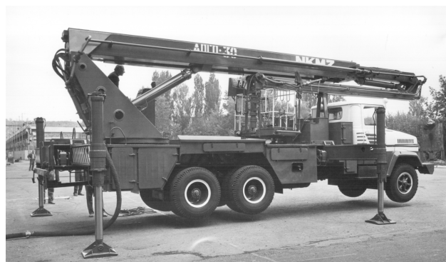
Рис. 1. Колісний автопідъемник гідравлічний пожежний (АППП-30) з висотою розгорнутої стріли до 30 м / Fig. 1. Articulated forklift truck hydraulic fire (APGP-30) with a boom deployment of up to 30 m
